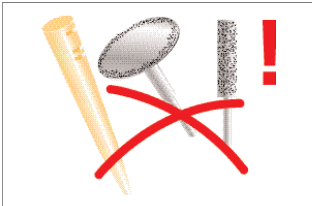
Der CosmoPost darf unter keinen Umständen mit Retentionsrillen versehen werden.
