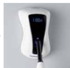
Mesure de l'intensité lumineuse avec Bluephase Meter
