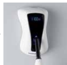
Μέτρηση της έντασης του φωτός με τον μετρητή Bluephase Meter
