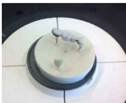
Abb. 22: Das grössere Brennobjekt muss immer im Vordergrund zur IR-Kamera positioniert werden
