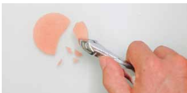
Fig.4: I campioni vengono spezzati per determinare il peso iniziale
