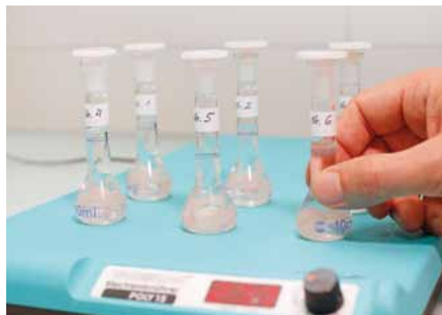
Fig. 5: Estrazione del metilmetacrilato mescolando in acetone per 72 ore
