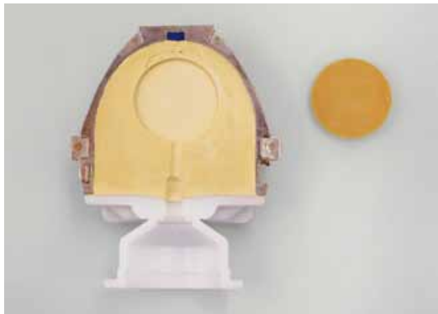
Fig. 2: Messa in rivestimento della forma in silicone per determinare il contenuto di monomero residuo.
