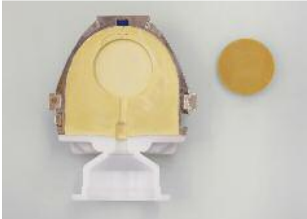
Bild 2: Einbettung der Silikonform zur Bestimmung des Restmonomergehaltes
