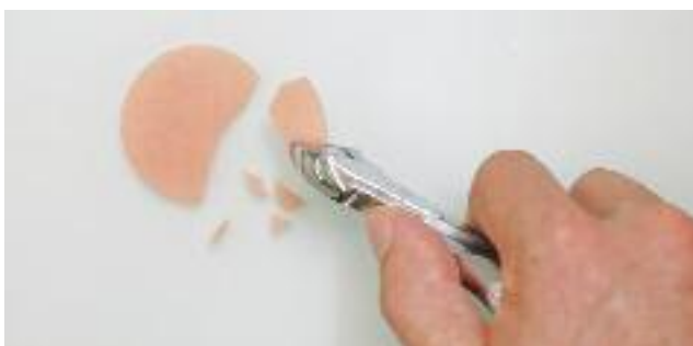
Bild 4: Zerkleinern des Probekörpers für die Einwaage
