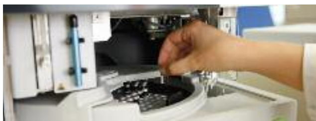
Bild 1: Analyseproben im Gaschromatographen
