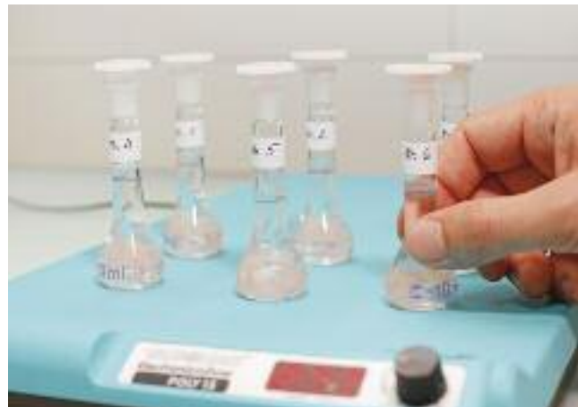
Bild 5: Extraktion des Methylmethacrylates durch Rühren in Aceton während 72 Std.
