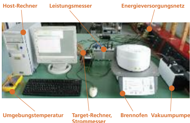
Abb. 1. Foto des Messaufbaus
