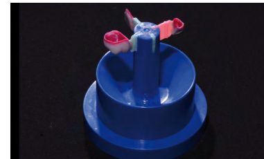
IPS Multi Muffelbasis mit angewachsenen Restaurationen
