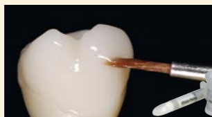
Auftrag von IPS e.max Ceram Glaze Paste oder Pulver vor dem Malfarbenbrand
