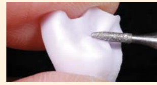
Funktionelle Bereiche mit einem feinen Diamanten überschleifen
