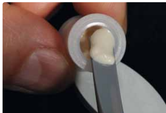
Mit dem IPS Spatel prüfen, ob das Material richtig aufgemischt und die Konsistenz gleichmässig ist.
