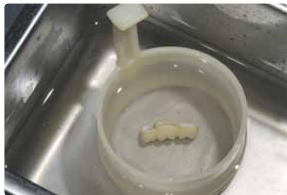
Anhaftende Rückstände des IPS Object Fix Putty oder Flow mit Ultraschall im Wasserbad und/oder mit Dampfstrahler reinigen.
