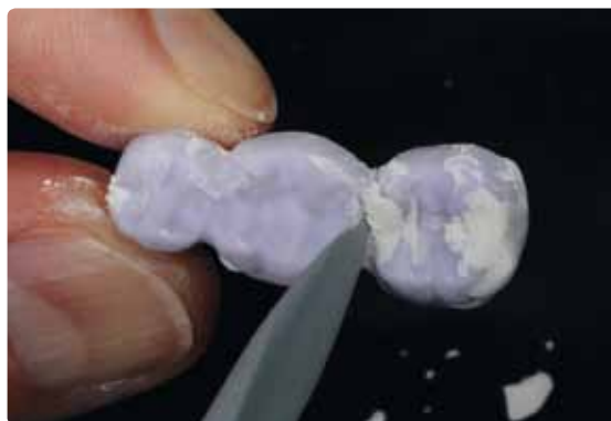
Überschuss des IPS e.max CAD Crystall./Connect mit dem IPS Spatel entfernen.
