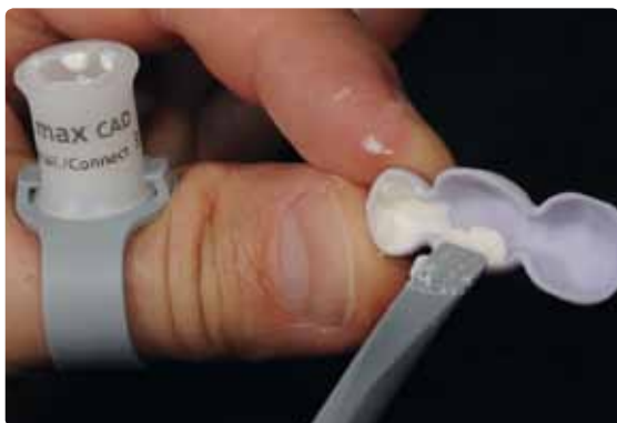
IPS e.max CAD Crystall./Connect mit dem IPS Spatel der Kapsel entnehmen und auf die Innenflächen der IPS e.max CAD-Verblendstruktur auftragen und ...
