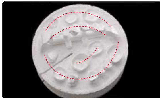
Es können Gerüste mit und ohne Sinterstützstruktur gleichzeitig gesintert werden. Programmauswahl beachten! Gerüste dürfen sich nicht berühren. Keine Gerüste über dem Sägeschnitt platzieren.
