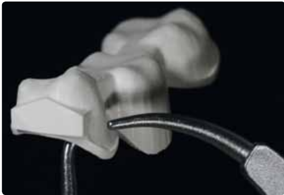
Neben der Ansatzstelle die Schichtstärke messen und an der Ansatzstelle das IPS e.max ZirCAD-Gerüst auf diese Schichtstärke reduzieren.
