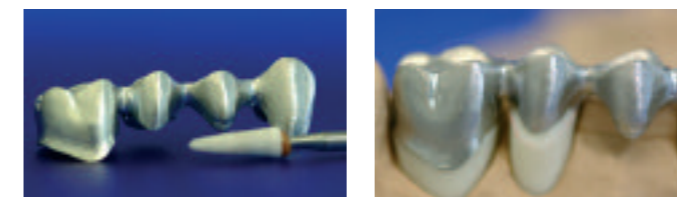
Bearbeitung des Gerüsts mit Hartmetallfräsen oder keramisch gebundenen Schleifinstrumenten
