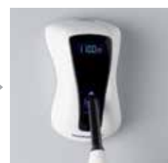
Meting van de lichtintensiteit met de Bluephase Meter
