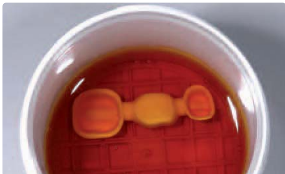
Gerüst für 2 Minuten in das Colouring Liquid tauchen, um eine Durchdringung von einer Materialstärke von \geq 0,7 mm zu erreichen.
