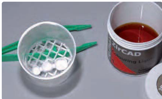
Arbeitsgefäß ca. 2 cm hoch mit Colouring Liquid befüllen und getrocknetes IPS e.max ZirCAD Gerüst mit der Okklusalfäche zum Boden hin im Siebeinsatz platzieren.
