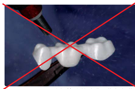
Gerüst nicht mit Al 2 O 3 oder Glanzstrahlperlen abstrahlen.
