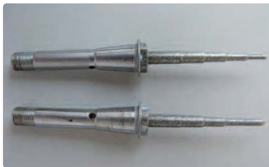
Zur Verarbeitung der grossen Blöcke die einteiligen Schlefkörper verwenden.
