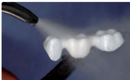
Vor der Verblendung IPS e.max ZirCAD Gerüst abdampfen
