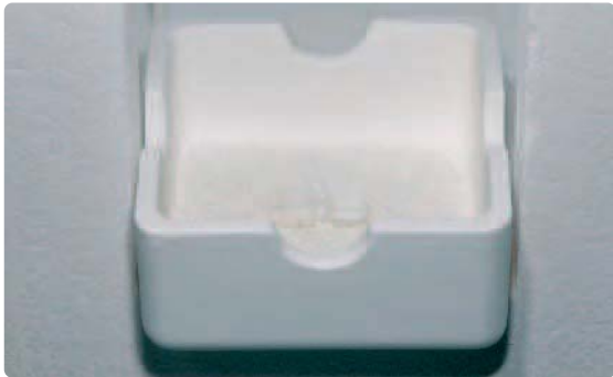
Nach Beendigung des Sinterprozesses Sinterschale auf Raumtemperatur abkühlen lassen und aus dem Sintramat nehmen.
