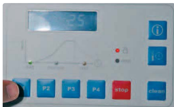
Taste "P1" drücken und Sinterprogramm startet automatisch und Ofentür wird verriegelt.
