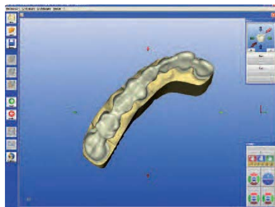
Gerüstvorschlag mit den Design-Tools der klinischen Situation anpassen. Mindestwandstärken und -verbinderquerschnitte beachten.
