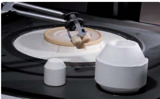
Heisse Muffel nach dem Vorwärmzyklus mit den kalten Rohlingen bestücken und dem kalten IPS One-Way-Plunger 300 g bestücken und Pressvorgang durchführen.
