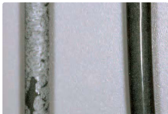
Korrodiertes Heizelement (links). Reinigungsbrand so oft wiederholen, bis die Oberfläche des Heizelements frei von Verunreinigungen ist und glasig erscheint (rechts).
