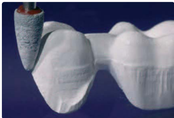
Mit geeigneten Schleifkörpern ungesintertes Gerüst überarbeiten.
