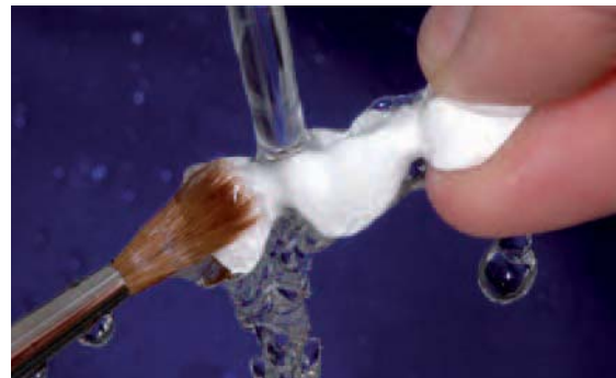
Schleifstaub unter fliessendem Wasser gründlich vom Gerüst abspülen, ggf. einen Pinsel zur Hilfe nehmen.
